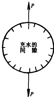
图 2-23 电致伸缩力示意图
