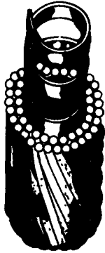
图 2-15 具有螺旋支撑的中空线芯示意图
