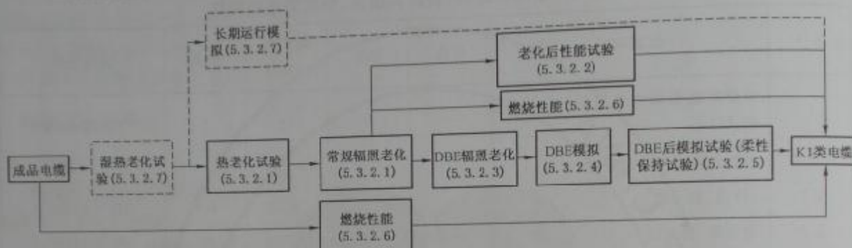
图 B.1 K1 类电缆 1E 级功能验证试验流程图
