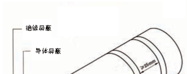
图 B1a 导体屏蔽体积电阻率测量
